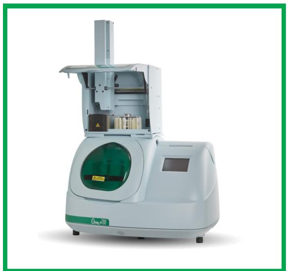
Operatiile de dilutie, pipetatare, incubare, spalare si citire, sunt **asigurate automat**. Probele sunt pipetate de catre utilizator in strip.
