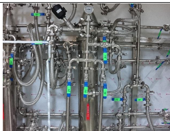
Figura 6. Detaliu al instalației pentru decolmatare a coloanelor prin backflush.
