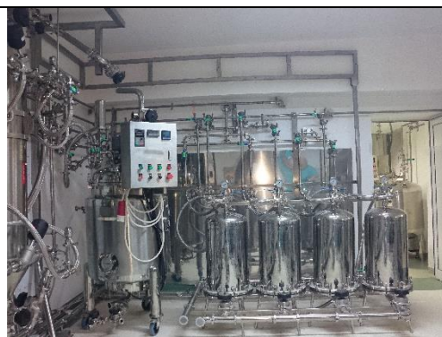
Figura 4. Sistemul pentru laminare și filtrarea primară a suspensiei de atelocolagen.
