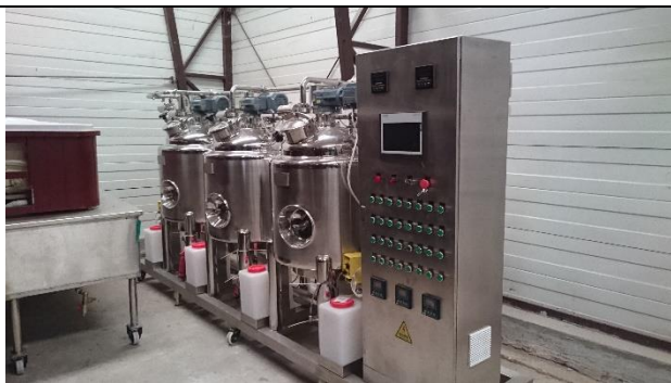
Figura 7. Instalația pentru curățare / spălare în circuit închis (clean-in-place).
