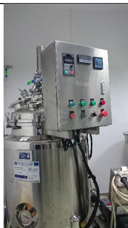
Figura 2. Vas de reacție pentru solubilizarea enzimatică a atelocolagenului.
