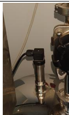
Figura 11. Traductor de vacuum necesar amorsării transferului de lichide în instalația pilot.
